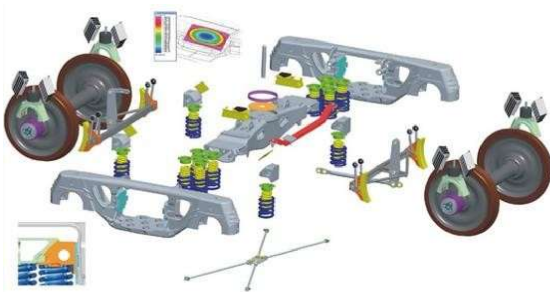
Рисунок 2.11 – Елементи візка моделі 18-4129 (запозичено із джерела [81])
