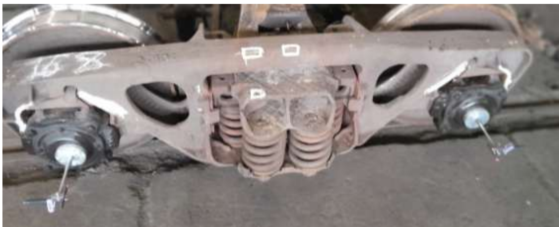
Рисунок 4.9 – Пристрій для контролю перекосу колісних пар (варіант установки на оглядові кришки букс)
